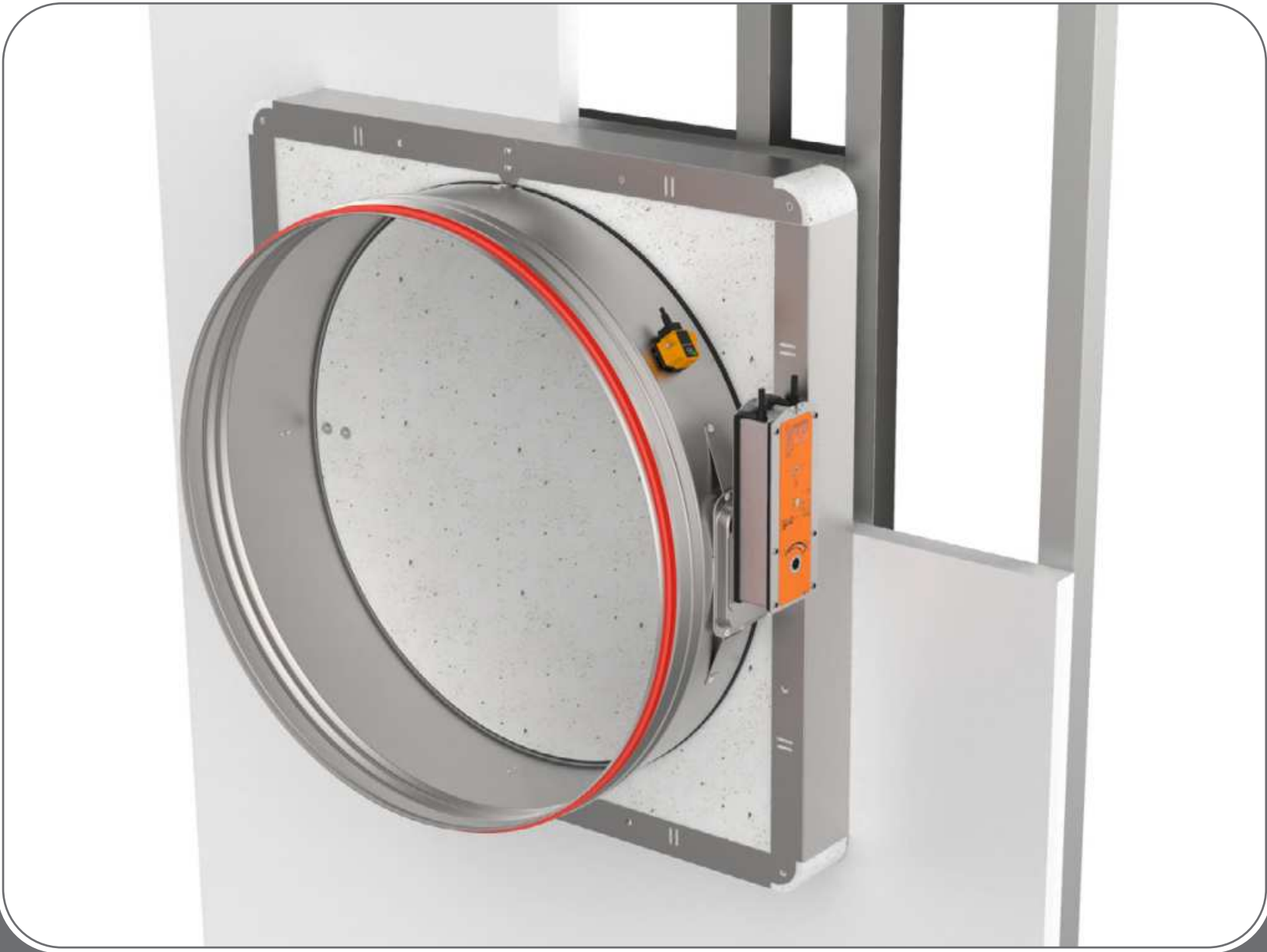
E-FDC-MF2 Serranda tagliafuoco ( \varnothing d > 625 mm) installazione in parete di vani (90 mm) con borchie metalliche
